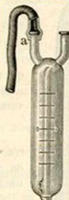
La figure 4 représente un ventimètre à mercure, d'après "NOTTEBOHM", destiné à mesurer la pression des machines soufflantes. —
